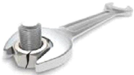
端子连接时拧的用力过猛，导致端子拧变形或断裂，或者，拧的过松，连接部虚连。
